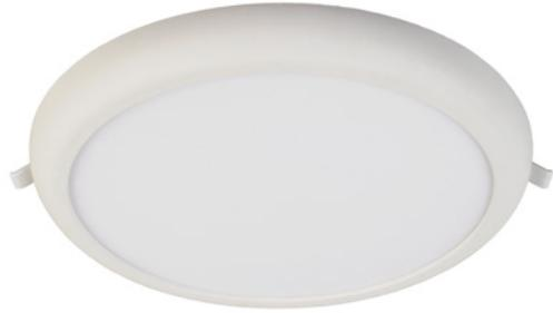
Deckeneinbauleuchten lassen sich dezent in private wie gewerbliche Räume integrieren, doch wenn ein Austausch ansteht, kann der vorhandene Deckenausschnitt zum Problem werden. Die ZAURAK-Serie kommt mit einer einstellbaren Befestigungsklammer, mit der sich auch größere bzw. kleinere Deckenausschnitte nutzen lassen. Zudem verfügt die ZAURAK über eine geringe Einbautiefe für den universellen Einsatz. Im Lieferumfang enthalten sind zwei austauschbare Abdeckringe in Silber und Schwarz.
