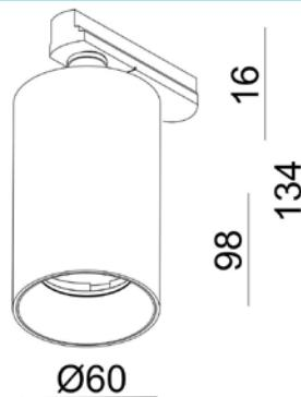
Der CAN-Spot für das 3-Phasenstromschienensystem bietet eine robuste und flexible Beleuchtungslösung für gewerbliche und private Anwendungen. Der GU10-Sockel ermöglicht einen schnellen und unkomplizierten Leuchtmittelwechsel, das schraubbare Zylindergehäuse einen werkzeuglosen Zugang. Der CAN-Spot für das 3-Phasenstromschienensystem ist Teil einer umfangreichen Leuchtenserie, die auch als Pendel-, Wand-, Lese und Außenleuchte erhältlich ist.
