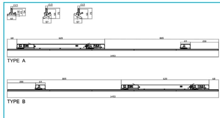
Die LINEAR PRO TILT 3-Phasen Stromschieneleuchte ist die ideale Lösung für die Beleuchtung von Verkaufsregalen. Diese Leuchte bietet eine perfekte Kombination aus Funktionalität und Vielseitigkeit. Sie kann nach unten arretiert oder um bis zu 30° zu jeder Seite geschwenkt werden, um das Licht präzise auszurichten.
