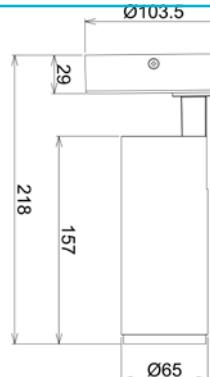
Die Deckenleuchten der LUCEA-Serie mit CCT sind in den Leistungsstufen 10, 15, 20 und 30 Watt erhältlich. Sie bieten je nach Ausführung bis zu 2.900 Lumen Lichtleistung. Durch den Tausch von optional erhältlichen Linsen, lässt sich der Abstrahlwinkel verengen oder erweitern. Über einen CCT-Switch lässt sich die Farbtemperatur in 2 Stufen einstellen.
