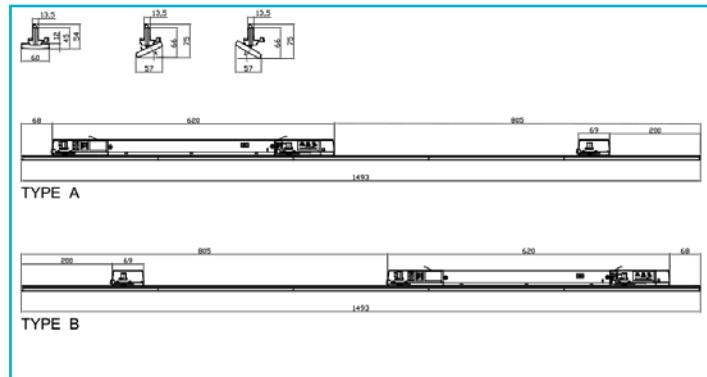
Die LINEAR PRO TILT 3-Phasen Stromschieneleuchte ist die ideale Lösung für die Beleuchtung von Verkaufsregalen. Diese Leuchte bietet eine perfekte Kombination aus Funktionalität und Vielseitigkeit. Sie kann nach unten arretiert oder um bis zu 30° zu jeder Seite geschwenkt werden, um das Licht präzise auszurichten.
