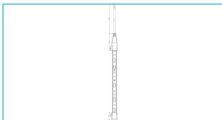
Die 230V LED-Stripes sind hervorragend geeignet, wenn die Anforderungen und Schwerpunkte auf flexible, wassergeschützte und lang zu beleuchtende Strecken in Innen- und Außenbereichen liegen. Die Auslieferung erfolgt anschlussfertig mit montierten IP44 Konturenstecker und vergossener Endkappe. Anwendungen von großen Strecken, wie an Gebäuden oder Hotelflure können am Stück bis zu 50m betrieben werden.
