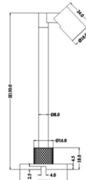
Kleine Helfer, große Wirkung. Mit den HERCULIS Displayleuchten im hochwertigem Aluminiumgehäuse erreichen Sie sämtliche Ecken einer Vitrine. Hierzulässt sich der Leuchtenkopf mit seinem 40° Abstrahlwinkel frei in jede Richtung drehen und schwenken. Zudem ermöglichen die intelligente Kabelführung und das steckfertige System die einfache Auf- und Einbaumontage in Vitrinen, Theken, Verkaufsbereichen oder im Wohnz
