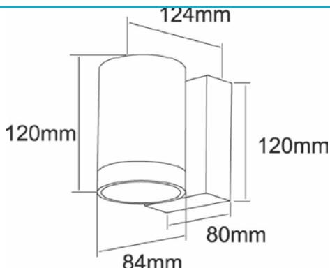
Die MOBBY II ist eine moderne IP55-Wandaufbauleuchte für den Einsatz im Außenbereich – wahlweise erhältlich als SINGLE-Variante mit nach unten gerichtetem Lichtaustritt oder als DOUBLE-Variante mit beidseitigem Lichtaustritt. Das warmweiße Licht (3.000 K) der kompakten MOBBY II sorgt an Hauswänden, Säulen und anderen Bereichen für ein angenehmes, einladendes Ambiente.
