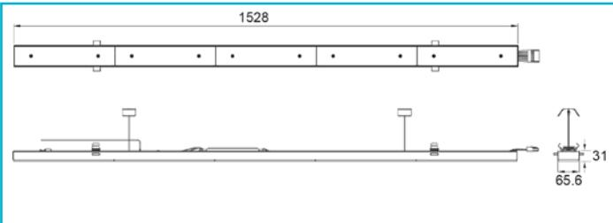
Das SANOTRUNK Lichtbandsystem ist eine speziell entwickelte Sanierungslösung zur schnellen und kosteneffizienten Modernisierung bestehender T5- und T8-Lichtbandsysteme. Durch die komplette Weiterverwendung der vorhandenen Tragschienensysteme wird der Installationsaufwand minimiert und eine werkzeuglose Montage ermöglicht.
