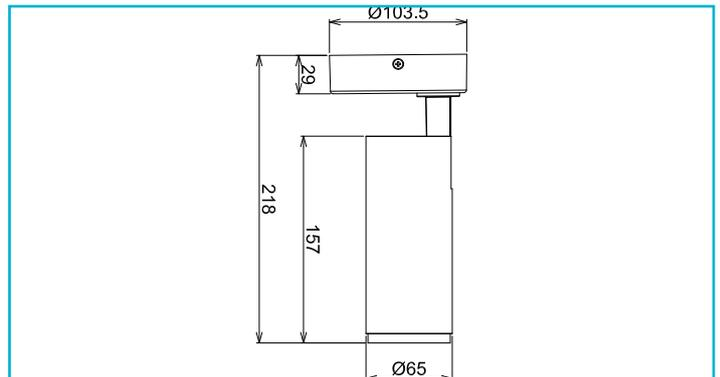
Die Deckenleuchten Dim-to-warm der LUCEA-Serie sind in den Leistungsstufen 10 W erhältlich. Sie bieten bis zu 750 Lumen Lichtleistung. Durch den Tausch von optional erhältlichen Linsen, lässt sich der Abstrahlwinkel verengen oder erweitern.
