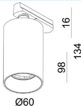
Der CAN-Spot für das 3-Phasenstromschienensystem bietet eine robuste und flexible Beleuchtungslösung für gewerbliche und private Anwendungen. Der GU10-Sockel ermöglicht einen schnellen und unkomplizierten Leuchtmittelwechsel, das schraubbare Zylindergehäuse einen werkzeuglosen Zugang. Der CAN-Spot für das 3-Phasenstromschienensystem ist Teil einer umfangreichen Leuchtenserie, die auch als Pendel-, Wand-, Lese und Außenleuchte erhältlich ist.
