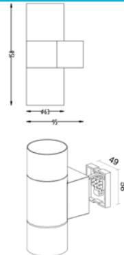
ACHERNAR mit viel Flexibilität: Der GU10-Sockel im schlichten Aluminium-Druckgussgehäuse ermöglicht die freie Wahl des Leuchtmittels für jede Anwendung.
