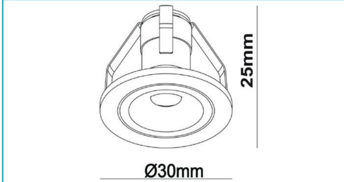
Die PUNTO LUMI ist eine filigrane LED-Deckeneinbauleuchte mit warmweißem Licht (3.000 K), die sich dank ihres geringen Einbaudurchmessers (18 mm) auch hervorragend für den Einbau in Möbeln anbietet. Zudem ist die PUNTO LUMI mit ihrer IP44-Zertifizierung gegen Spritzwasser geschützt und eignet sich damit für den Einsatz in Feuchträumen, wie zum Beispiel Badezimmern. Die Einbauleuchte ist in weißer und silberfarbener Gehäuseausführung erhältlich.
