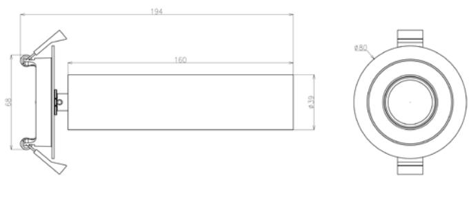
Für unsere SLIM-Leuchtenserie gibt es passende Einbaustrahler. Der Leuchtenkörper aus Aluminium Druckguss ist dabei immer gleich groß [300 x 39mm]. Die SLIM Einbaustrahler haben das gängige Einbaumaß von 68 mm. Damit eignen sich die einflammigen Einbaustrahler besonders gut für Verkaufsflächen, Empfangsbereiche oder auch Hotel und Gastronomie.
