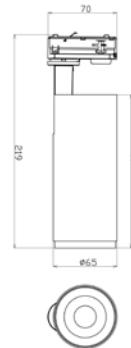
Für das 1-Phasen 230V Stromschiensystem bieten wir Spots der LUCEA-Serie an. In der Version als Deckenleuchte gibt es sie mit 6, 10, 15 und 20 W und ermöglicht damit eine maximale Lichtleistung von bis zu 3000 Lumen.
