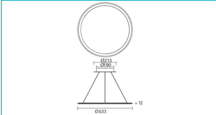
Die LED-Pendelleuchte ist mit einer transparenten Acrylglasscheibe für eine weiche direkte und indirekte Lichtverteilung ausgestattet, die im ausgeschalteten Zustand nahezu transparent ist. Im eingeschalteten Zustand verteilt die Scheibe das Licht nahezu blendfrei.
