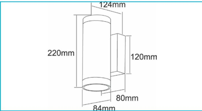
Die MOBBY II ist eine moderne IP55-Wandaufbauleuchte für den Einsatz im Außenbereich – wahlweise erhältlich als SINGLE-Variante mit nach unten gerichtetem Lichtaustritt oder als DOUBLE-Variante mit beidseitigem Lichtaustritt. Das warmweiße Licht (3.000 K) der kompakten MOBBY II sorgt an Hauswänden, Säulen und anderen Bereichen für ein angenehmes, einladendes Ambiente.
