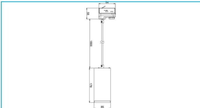
Die passenden Pendelleuchten der LUCEA-Serie für das 3-Phasen 230 V Stromschienensystem sind in den Versionen 10, 15, 20 W erhältlich und bieten bis zu 2.000 Lumen Lichtleistung. Die maximale Abhängung beträgt 1.800 mm. Über optionale Linsen lassen sich die einzelnen Modelle in ihrem Abstrahlwinkel verengen oder erweitern. Das Gehäuse der Lucea-Leuchten besteht aus Aluminium-Druckguss
