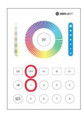
Tipp: Bei Fernbedienungen mit mehreren Zonen können Sie mit der "Master-OFF-Taste" gleichzeitig die Mindesthelligkeit für alle mit der Fernbedienung verbundenen Triac-Dimmer einstellen
