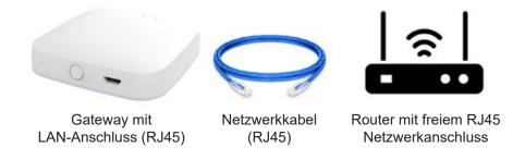
3. Zigbee 3.0 Gateway extern, mit drahtloser Router-Anbindung via WiFi:
