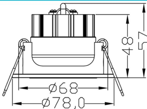
Die Deckeneinbauleuchte COB 68 RGBW verfügt über einen eigens entwickelten RGBW-Chip [RGB + Warmweiß], der in Kombination mit dem integrierten Reflektor eine homogene Farbmischung gewährleistet und verschiedene Lichtstimmungen über diverse Lichtsteuerungsoptionen ermöglicht. Damit eignet sich die Innenleuchte sowohl für den Einsatz in Wohnräumen als auch in Bars, Clubs sowie weiteren Umgebungen, die auf eine flexible Beleuchtung Wert legen.
