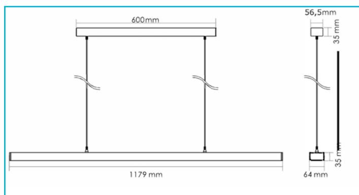
Die Pendelleuchte ist eine passende Ergänzung zur OFFICE THREE MOTION Stehleuchte. Da der Blendwert bei unter 10 liegt, kann man diese technisch durchdachte Leuchte beinahe als vollkommen blendfrei bezeichnen. Die nach oben gerichteten LED schaffen Raumlicht, während die nach unten gerichteten LED klar definiertes und kraftvolles Licht auf den Arbeitsbereich strahlen.
