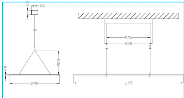
Die LED Pendelleuchte hat für eine direkte und indirekte Lichtverteilung ein transparentes Glas, welches im ausgeschalteten Zustand fast durchsichtig ist. Bei eingeschaltetem Licht verteilt die Scheibe das Licht beinahe blendfrei.
