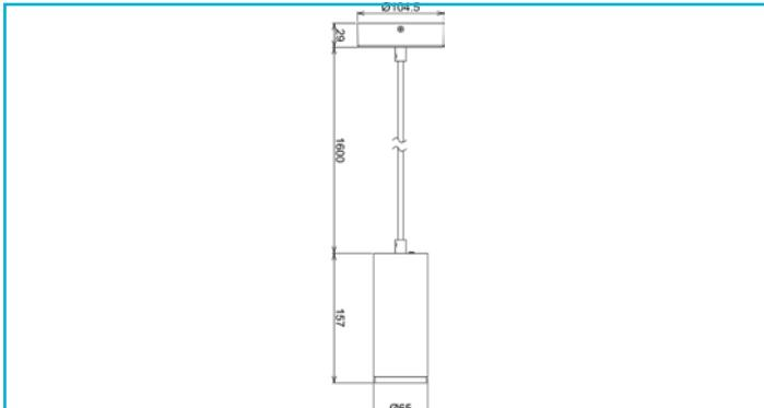
Die Pendelleuchten der LUCEA-Serie sind in den Versionen 6, 10 W erhältlich und bieten bis zu 1300 Lumen Lichtleistung. Die maximale Abhängung beträgt 1800 mm. Über optionale Linsen lassen sich die einzelnen Modelle in ihrem Abstrahlwinkel verengen oder erweitern. Das Gehäuse der LUCEA-Leuchten besteht aus Aluminiumdruckguss.
