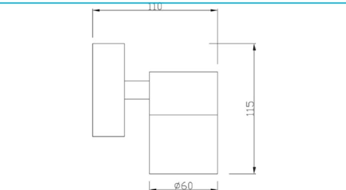
Kompakt, dezent, mit großer Wirkung - Die Wandaufbauleuchten der Zilly-Serie lassen sich auf Terrassen, an Hauswänden oder im Eingangsbereich von Wohnumgebungen installieren und machen mit ihrem Edelstahl-Gehäuse und dem nach oben und / oder unten offenen Lichtaustritt an jeder Position eine gute Figur. Die dimmbaren Leuchtquellen mit jeweils maximal 35W sitzen in GU10-Fassungen. Es gibt sie als Varianten mit und ohne Bewegungsmelder
