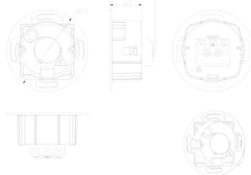
Die Wandeinbauleuchte ALWAID 2 passt durch ihre kompakte Bauform in alle 68 mm Schalterdosen mit normaler und tiefer Bauform. Außerdem benötigt sie kein zusätzliches Netzteil. Mit ihren zahlreichen Abdeckungen fügt sie sich sicher in ihre Umgebung ein und präsentiert ein schönes indirektes Licht. Bei dem Artikel handelt es sich nur um die Base, Abdeckungen sind im Lieferumfang nicht enthalten!
