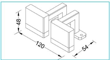
GehäusematerialAluminiumGehäusefarbeSilberGehäuseoberflächeGlänzendMaterial LichtaustrittKunststoffFarbe LichtaustrittWeißOberfläche LichtaustrittOpal
