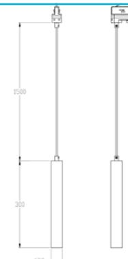
Für das Stromschiensystem gibt es passende Pendelleuchten der SLIM - Serie. Der Leuchtenkörper aus Aluminium Druckguss ist dabei immer gleich groß [300 x 39mm]. Die Pendelleuchten für die Stromschienen ermöglichen eine Abhängung von maximal 180 cm.
