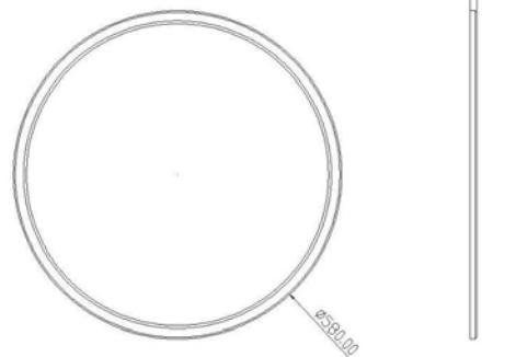
Die LED-Pendelleuchte ist mit einer transparenten Acrylglasscheibe für eine weiche direkte und indirekte Lichtverteilung ausgestattet, die im ausgeschalteten Zustand nahezu transparent ist. Im eingeschalteten Zustand verteilt die Scheibe das Licht nahezu blendfrei.
