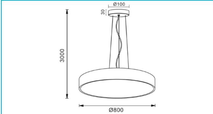
Die Pendelleuchten der MENKAR - Serie überzeugen mit cleveren Beleuchtungsfunktionen und hochwertigem Aluminium-Akzenten. Das separate Rücklicht (ca. 15 - 20 % indirekter Lichtanteil) ermöglicht eine dauerhafte indirekte Beleuchtung. Über einen CCT-Switch lässt sich die Lichtfarbe in 2 Stufen [3000/4000K] einstellen.
