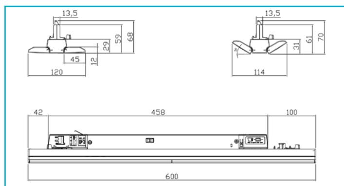
Die LINEAR PRO FOLD 3-Phasen Stromschieneleuchte ist die ideale Lösung für die Beleuchtung von Verkaufsregalen. Durch ihre spezielle Optik eignet sie sich hervorragend für die Beleuchtung von Regalgängen. Damit ist sie in der Lage, typische Anwendungsszenarien auf beiden Seiten des Ganges über die gesamte Höhe gleichmäßig auszuleuchten. Gleichzeitig sorgt der diffuse Lichteinsatz in der Mitte für eine gleichmäßige Ausleuchtung des Ganges selbst.
