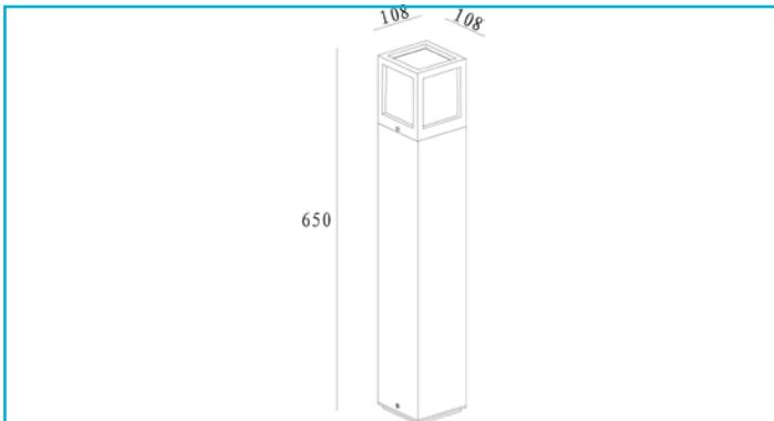
Die Stehleuchten der FACADO-Serie finden bereits seit einiger Zeit auf gepflasterten Gehwegen im Gartenbereich Verwendung. Mit der FACADO werden die klassischeleganten Außenleuchten (IP44) noch vielseitiger. Dank E27-Sockel lässt sich das Leuchtmittel bei Bedarf wechseln und an die gewünschte Lichtstimmung anpassen. Die FACADO ist in zwei Höhenausführungen (65 und 100 cm) erhältlich.
