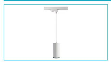
Die passenden Pendelleuchten der LUCEA-Serie für das 3-Phasen 230 V Stromschienensystem sind in den Versionen 10, 15, 20 W erhätlich und bieten bis zu 2.000 Lumen Lichtleistung. Die maximale Abhängung beträgt 1.800 mm. Über optionale Linsen lassen sich die einzelnen Modelle in ihrem Abstrahlwinkel verengen oder erweitern. Das Gehäuse der Lucea-Leuchten besteht aus Aluminium-Druckguss
