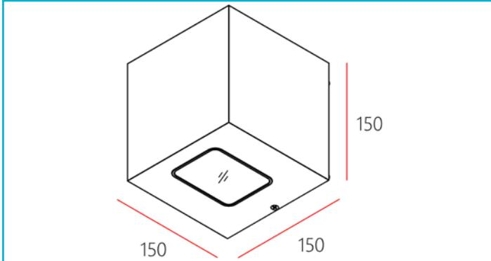
Die quadratische JABBAH setzt auf integrierte COB-LEDs in warmweißer Ausführung und strahlt ihr Licht mit 75° asymmetrisch in Kegelform an Wände – in der einfachen Variante mit 915 Lumen, als UP AND DOWN Version mit insgesamt 1850 Lumen. Zudem lässt sich die beidseitige JABBAH über einen Dipschalter auf 60% Lichtstrom dimmen, falls ein dezentener Lichtaustritt gewünscht ist.
