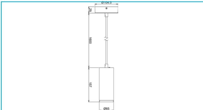
Die Pendelleuchten Dim-to-warm der LUCEA-Serie sind in 10 W erhältlich und bieten bis zu 750 Lumen Leistung. Die maximale Abhängung beträgt 1.600 mm. Über optionale Linsen lassen sich die einzelnen Modelle in ihrem Abstrahlwinkel verengen oder erweitern. Das Gehäuse der LUCEA-Leuchten besteht aus Aluminium-Druckguss.
