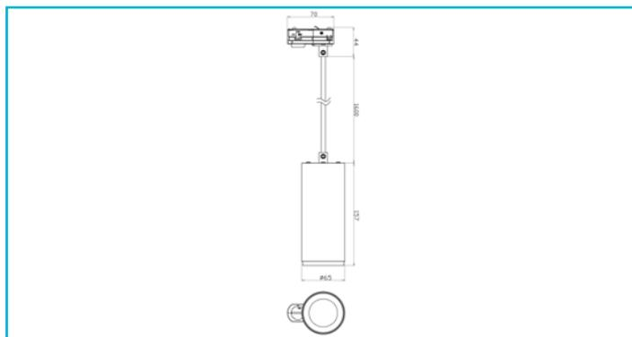
Die passenden Pendelleuchten der LUCEA-Serie für das 3-Phasen 230 V Stromschienensystem sind in den Versionen 10, 15, 20 W erhältlich und bieten bis zu 2.000 Lumen Lichtleistung. Die maximale Abhängung beträgt 1.800 mm. Über optionale Linsen lassen sich die einzelnen Modelle in ihrem Abstrahlwinkel verengen oder erweitern. Das Gehäuse der Lucea-Leuchten besteht aus Aluminium.
