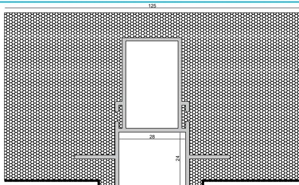
Das patentierte DEKO LIGHT COMBO PROFILSYSTEM ist eine neue, montagefreundliche Profil-in-Profil-Lösung für die Installation von Lichtlinien in Fassaden, Gärten, Wohnräumen und vielem mehr.
