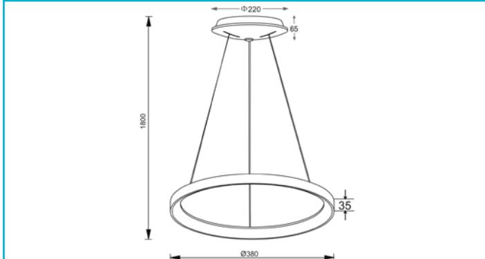
Die Pendelleuchten der MEROPE-Serie vereinen zeitlose Eleganz und reduzierte Modernität. Erhältlich in den Durchmessern 380, 580 und 780 mm, lässt sich die Lichtfarbe [3000/4000K] vor der Installation über einen CCT-Switch auswählen. Die Außenseite setzt auf gebürstetes Aluminium in den Farben Kaffee und Silber bzw. matt gepulvert in Weiß und Schwarz.
