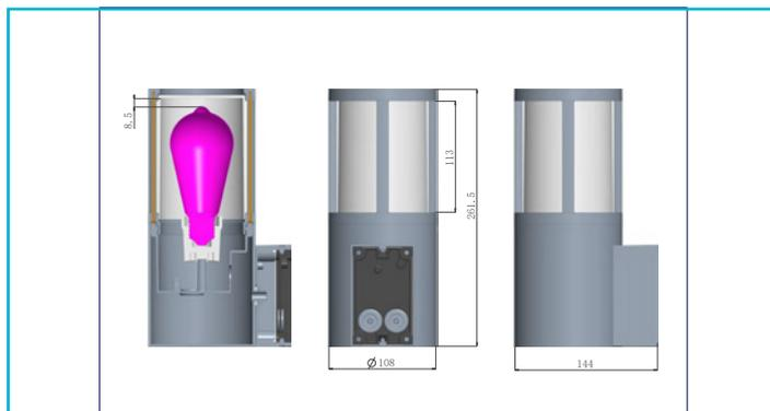
Die Wandleuchte FACADO ist unsere flexible Lösung für die Außenbeleuchtung. Durch zwei Kabeleinführungen ist eine Durchgangsverdrahtung problemlos möglich. Durch die abnehmbare Montageplatte mit Steckverbindung und die schraublosen Anschlussklemmen ist eine einfache und schnelle Montage problemlos möglich. Der neu entwickelte Leuchtenkopf sorgt für eine noch bessere Ausleuchtung. Durch die Schutzart IP 65 ist sie zudem besonders witterungsbeständig.
