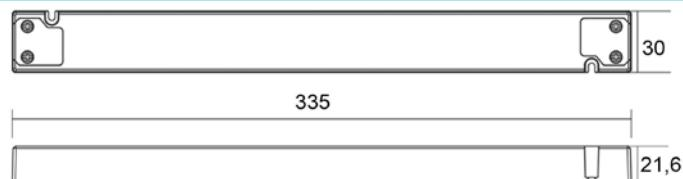
Die Netzgeräte-Serie hat mit bis zu 240 Watt bei gerade mal 32 x 23 mm Querschnitt ordentlich Leistung unter der „Haube“! Dieses Netzgerät passt somit in die meisten Deckenvouten, Schattenfugen oder auch bei allen anderen Einbausituationen mit wenig Platz.
