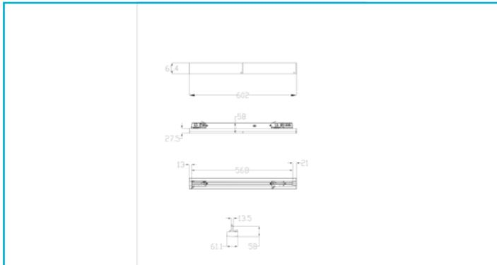
Die LINEAR PRO DALI 3-Phasen Stromschienenleuchte ist die ideale Lösung für die Beleuchtung von Verkaufsregalen. Durch ihre spezielle Optik eignet sie sich hervorragend für die Beleuchtung von Regalgängen. Damit ist sie in der Lage, typische Anwendungsszenarien auf beiden Seiten des Ganges über die gesamte Höhe gleichmäßig auszuleuchten. Gleichzeitig sorgt der diffuse Lichteinsatz in der Mitte für eine gleichmäßige Ausleuchtung des Ganges selbst.
