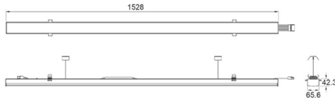
Das SANOTRUNK Lichtbandsystem ist eine speziell entwickelte Sanierungslösung zur schnellen und kosteneffizienten Modernisierung bestehender T5- und T8-Lichtbandsysteme. Durch die komplette Weiterverwendung der vorhandenen Tragschienensysteme wird der Installationsaufwand minimiert und eine werkzeuglose Montage ermöglicht.
