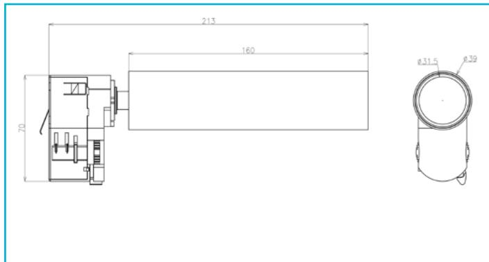
Für das 3-Phasen-Stromschiensystem gibt es passende Spots der SLIM - Serie. Der Leuchtenkörper aus Aluminium Druckguss ist dabei immer gleich groß [300 x 39mm]. Damit eignen sich die einflammigen SLIM Stromschieneleuchten besonders gut für Gastronomie- und Einzelhandel Projekte mit wechselnder Raumauflistung.
