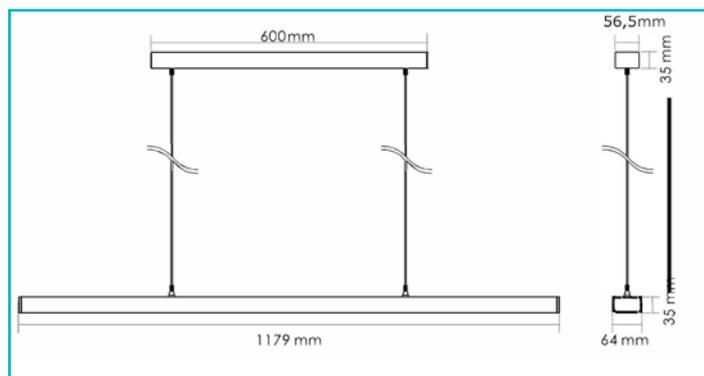
Die Pendelleuchte ist eine passende Ergänzung zur OFFICE THREE MOTION Stehleuchte. Da der Blendwert bei unter 10 liegt, kann man diese technisch durchdachte Leuchte beinahe als vollkommen blendfrei bezeichnen. Die nach oben gerichteten LED schaffen Raumlicht, während die nach unten gerichteten LED klar definiertes und kraftvolles Licht auf den Arbeitsbereich strahlen.
