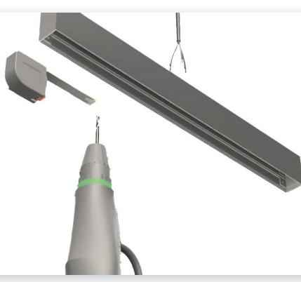
**4 - Montage- und Zuleitungsbohrungen**
