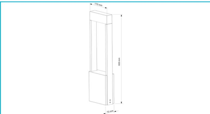
Mit ihrem außergewöhnlichen Material-Mix aus Aluminium-Druckgussgehäuse und einem Sockel aus witterungsbeständigen, glasfaserverstärktem Beton hebt sich die Outdoor-Stehleuchte CHERTAN schon rein optisch von anderen Modellen ab. Mit ihrem angenehm warmweißen Licht und einem Abstrahlwinkel von 120° eignet sich die Außenleuchte perfekt für den dekorativen Einsatz in Eingangsbereichen, auf Gehwegen oder im Garten.
