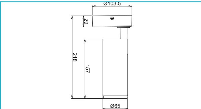
Die schwenk- und drehbaren Deckenleuchten der LUCEA-Serie DTW Tilt sind in der Leistungsstufe 10 W erhältlich. Sie bieten bis zu 750 Lumen Lichteistung. Durch den Tausch von optional erhältlichen Linsen, lässt sich der Abstrahlwinkel verengen oder erweitern. Mit der Dim-to-warm - Funktion verändert sich die Farbtemperatur beim Dimmen der Leuchten.
