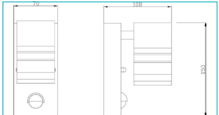
Kompakt, dezent, mit großer Wirkung - Die Wandaufbauleuchten der Zilly-Serie lassen sich auf Terrassen, an Hauswänden oder im Eingangsbereich von Wohnumgebungen installieren und machen mit ihrem Edelstahl-Gehäuse und dem nach oben und / oder unten offenen Lichtaustritt an jeder Position eine gute Figur. Die dimmbaren Leuchtquellen mit jeweils maximal 35W sitzen in GU10-Fassungen. Es gibt sie als Varianten mit und ohne Bewegungsmelder
