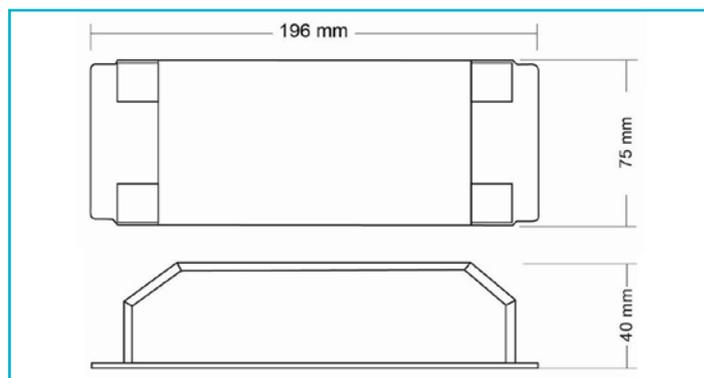
Einfach zu installierendes und kompaktes DMX-Kombigerät. In einem Gehäuse ist ein leistungsstarker 3 Kanal Dimmer sowie ein 135 Watt Netzgerät vereint. Hierdurch schnelle und einfache Installation. Steuerbar mit allen 3 Kanal Wandcontrollern und DMX Controllern.
