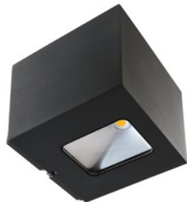
Die quadratische JABBAH setzt auf integrierte COB-LEDs in warmweißer Ausführung und strahlt ihr Licht mit 75° asymmetrisch in Kegelform an Wände – in der einfachen Variante mit 915 Lumen, als UP AND DOWN Version mit insgesamt 1850 Lumen. Zudem lässt sich die beidseitige JABBAH über einen Dipschalter auf 60% Lichtstrom dimmen, falls ein dezentener Lichtaustritt gewünscht ist.
