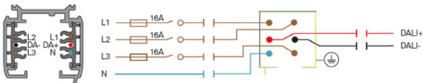
Bei Betrieb ohne Dali entfällt Anschluss Dali +/- / Operating without Dali, the Dali connection is not required.
